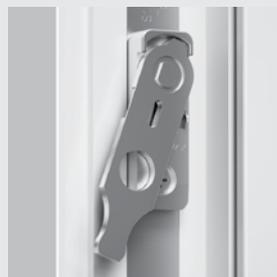
Фиксация центрального положения до момента монтажа. Работает при фальцлюфте от 10,5 до 14 мм. При необходимости возможна регулировка рамной части по высоте  $\pm 1$  мм.
