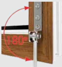
Откидывание штифта опоры нижней петли на 180°, что позволяет избежать контакта фиксатора биты шуруповерта с основанием штифта при вкручивании нижнего самореза.
