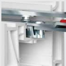
Фиксаторы в фурнитурном пазе для всех элементов створки позволяют закрепить элементы фурнитуры до момента ввинчивания саморезов и препятствуют их смещению от проектного положения.
