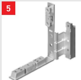
5 Обеспечивает плавное открывание створки и плотный прижим. Диапазоны регулировок: +/- 2 мм (по высоте), +/- 1 мм (на прижим).
