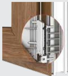
Несущий штифт нижней петли створки (6x26мм) изготовлен из высокопрочной стали и интегрирован в корпус петли, для придания ей дополнительной прочности при использовании на тяжелых створках.
