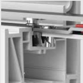
Наличие фиксаторов для фурнитурного паза позволяют предварительно закрепить фурнитуру на створке и препятствуют ее смещению от проектного положения при окончательной фиксации саморезами.
