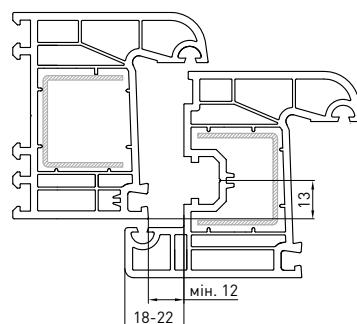
**Штульпові стулки з протилежним фурнітурним пазом**
