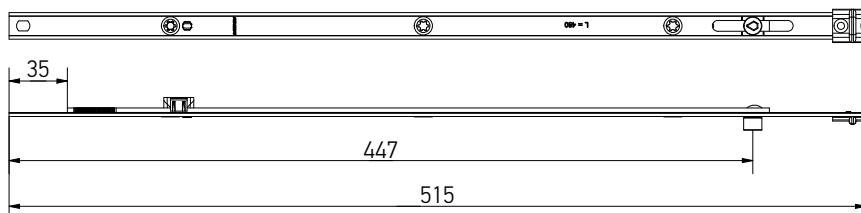
Лінійний подовжувач L=680 мм, 1 ML, з припіднімачем стулки
