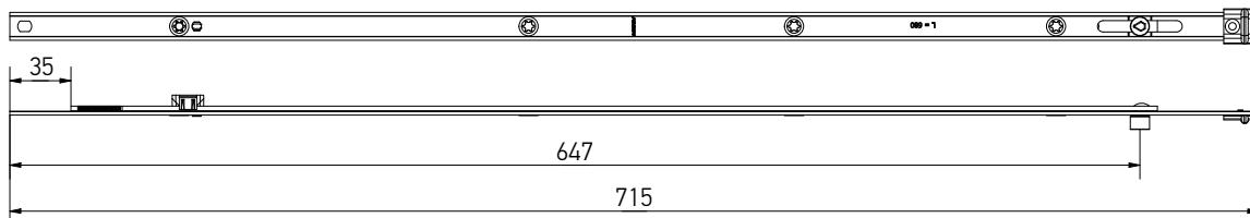
Лінійний подовжувач L=880 мм, 2 ML, з припіднімачем стулки
