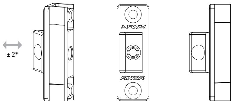
\* регулювання по горизонталі, мм
