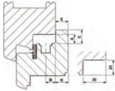
A Менфальцевый зазор 12,0 ±1мм
