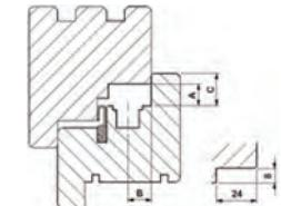
A Менфальцевый зазор 12,0 ±1мм
