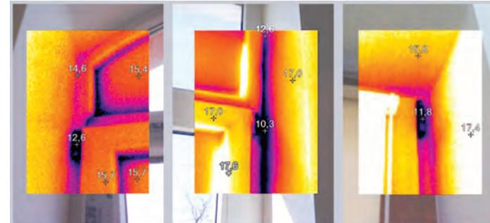
В случае выбора скрытых петель, вместо традиционных «внешних», повышается герметичность и энергоэффективность оконной конструкции. Скрытые петли не прерывают контур уплотнителя окна (контур остается замкнутым), что исключает продувания и промерзания в петлевой зоне.
