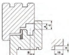
A Менфальцевый зазор 12,0 ±1мм
